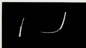
Bild 91. Oszillogramm einer Tunneliode bei Durchlaufen des negativen Kurvenastes; die zugehörige Zeit ist so klein, daß sie im Oszillogramm als Leuchtstrich nicht mehr sichtbar ist
